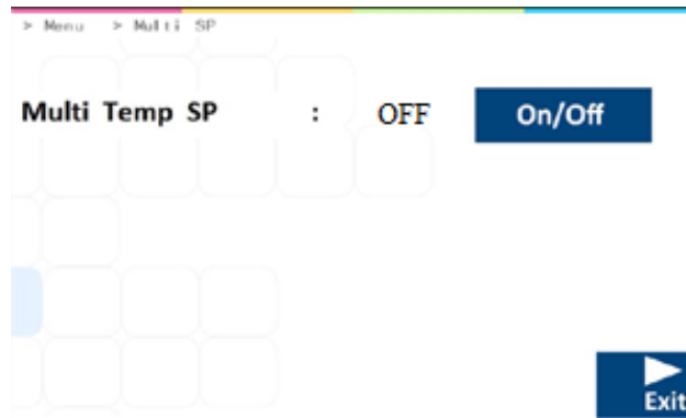
Figuur 13.27 Beeld multi-temperatuurinstelpunt in de MIRI® TL6 en MIRI® TL12 IVF incubator met meerdere kamers
