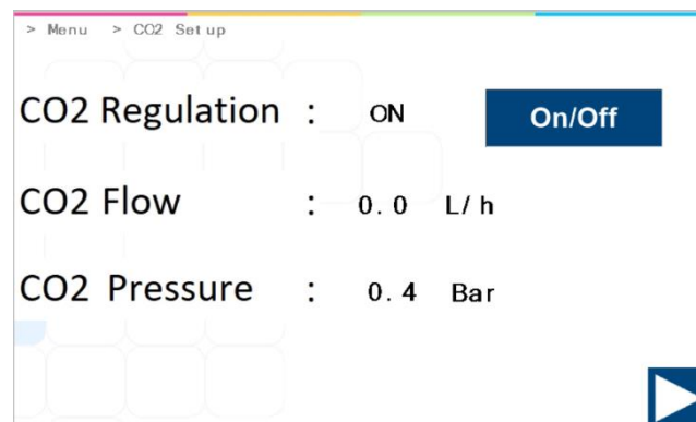
Figuur 13.25 Beeld CO 2 -instellingssubmenu in de MIRI® TL6 en MIRI® TL12 IVF incubator met meerdere kamers
