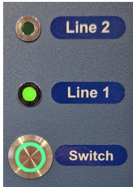
Figuur 20.2 De lijnomschakelaar van de MIRI® TL12 IVF incubator met meerdere kamers en een actieve Lijn 1
