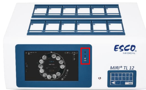
Figuur 20.1 Het vooraanzicht van de MIRI® TL12 IVF incubator met meerder kamers gemarkeerde knop voor het wijzigen van werklijnen en indicatie
