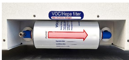
Figuur 12.3 Correct geïnstalleerd VOS/HEPA filter
