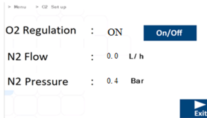
Figuur 16.4 Beeld O 2 -instellingensubmenu in de MIRI® TL6 en MIRI® TL12 IVF incubator met meerdere kamers
