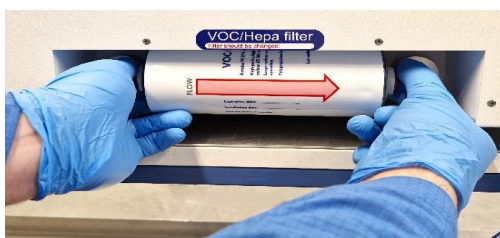
Figuur 12.2 VOS/HEPA filter plaatsen en verwijderen
